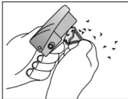
Um die gestanzten Ecken aus dem Auffangbehälter zu entsorgen, lösen Sie die Abdeckung von der Rückseite und leeren Sie den Behälter aus. Verschließen Sie diesen danach wieder.
